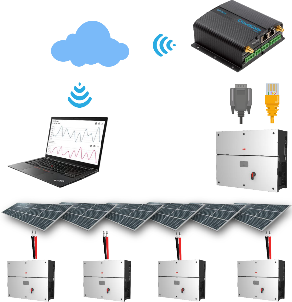
Şekil 2: Güneş enerji santralinin bulut teknolojisi aracılığı ile iletişimi
