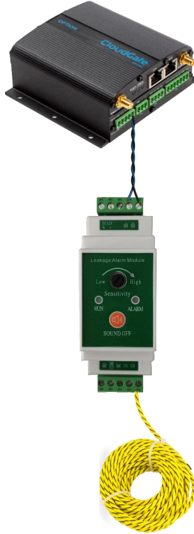
Şekil 1: Su Sızıntı Tespit Sensörü bağlantı şeması
